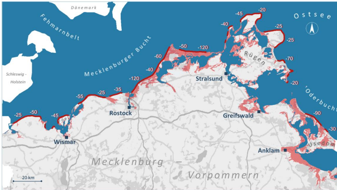
Abbildung 2: Gefährdungspotenzial für das Küstengebiet, rote Flächen: potenzielle Überschwemmungsgebiete bei Eintritt einer sehr schweren Sturmflut (>2,00m über Normal-Mittelwasser), die 2012 mit einem Wiederkehrintervall von 50-100 Jahren bewertet wurde. Rote Striche: erosionsgefährdete Küstenabschnitte mit Küstenrückgangsraten (m/100 Jahre) (STALU, 2012)
